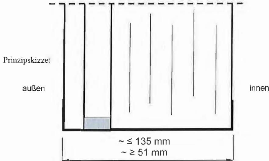
Brandschutzisolierverglasung, bestehend aus Verbund-Sicherheitsglas aus Floatglasscheiben mit zwischen liegenden Funktionsschichten sowie vorgesetzter Gegen-/Außenscheibe.
