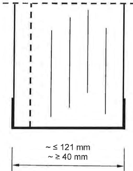
Brandschutz-Verbund-Sicherheitsglas, bestehend aus Floatglasscheiben mit zwischen liegenden Funktionsschichten und PVB-Folie.
