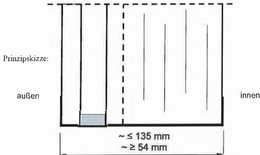
Brandschutzisoliertes Glas, bestehend aus Verbund-Sicherheitsglas aus Floatglasscheiben mit zwischen liegenden Funktionsschichten und PVB-Folie sowie vorgesetzter Gegen-/Außenscheibe.
