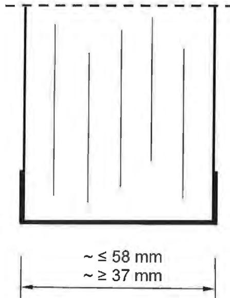
Brandschutz-Verbund-Sicherheitsglas, bestehend aus Floatglasscheiben mit zwischen liegenden Funktionsschichten.
