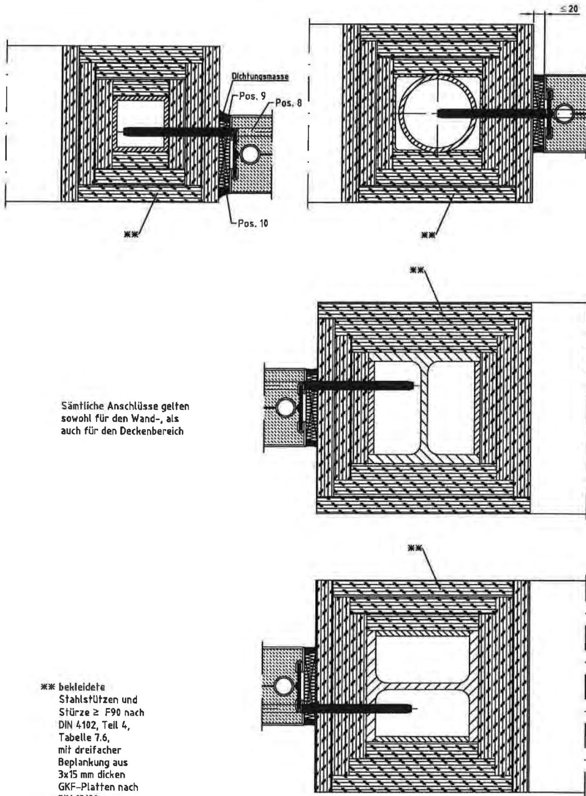
Sämtliche Anschlüsse gelten sowohl für den Wand-, als auch für den Deckenbereich
