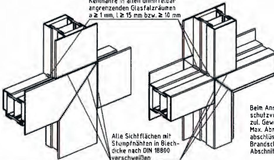
Alle Sichtflächen mit Stumpfnähten in Blechdicke nach DIN 18800 verschweißen
