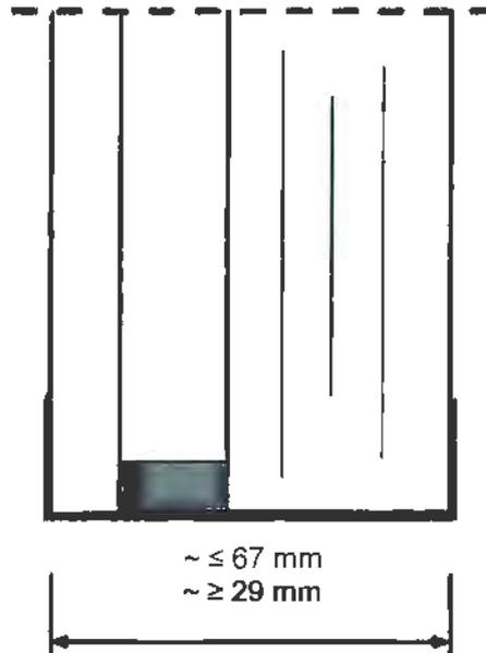
Brandschutzisoliertes Glas bestehend aus Verbund-Sicherheitsglas aus Floatglasscheiben mit zwischen liegenden Funktionsschichten sowie vorgesetzter Gegen-/Außenscheibe.
