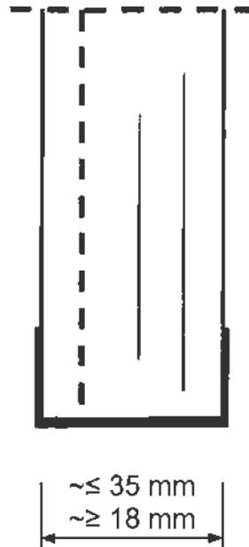
Brandschutz-Verbund-Sicherheitsglas bestehend aus Floatglasscheiben, mit zwischen liegenden Funktionsschichten und PVB-Folie.
