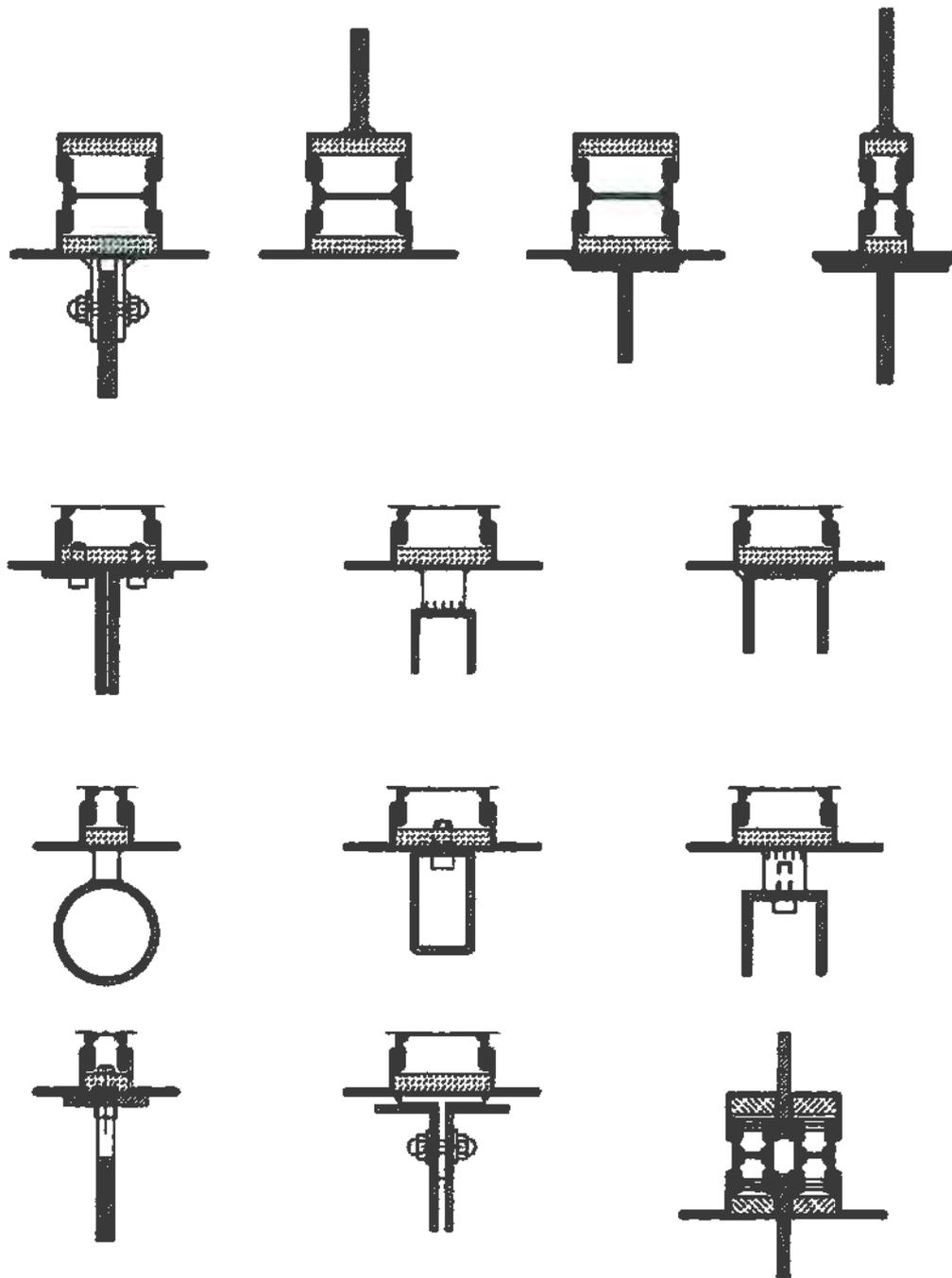
Verstärkungsprofile aus Metall, Anschlussart und Form freibleibend, nach statischer Berechnung.
